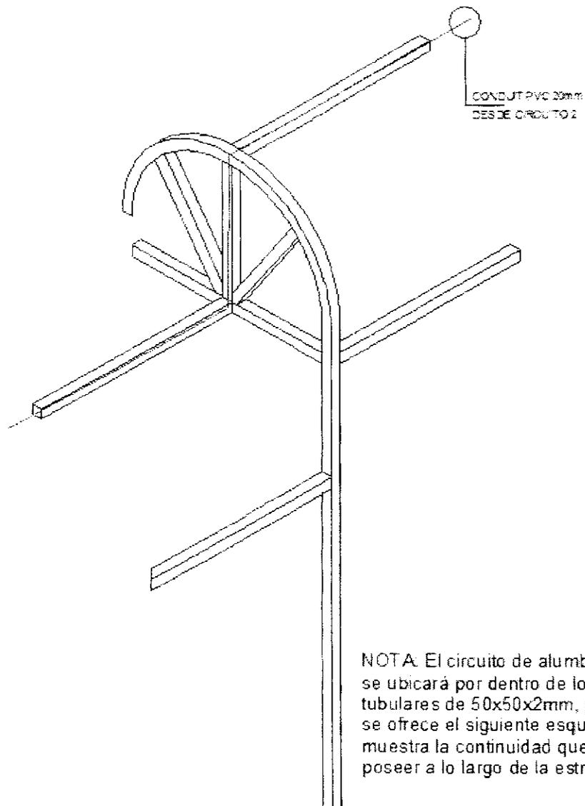
NOTA: El circuito de alumbrado N°2, se ubicará por dentro de los perfiles tubulares de 50x50x2mm, para esto se ofrece el siguiente esquema que muestra la continuidad que deberá poseer a lo largo de la estructura.
